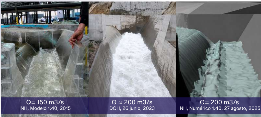
Validación del modelo físico y modelo matemático del embalse Ancoa vs. la crecida del 26 de junio de 2023.
