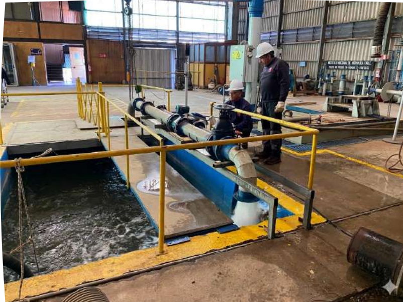
Banco de ensayo de bombas centrífugas horizontales.
