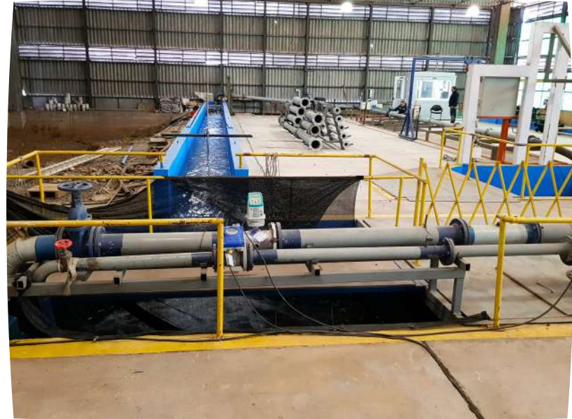
Banco de ensayo de bombas verticales y sumergibles.
