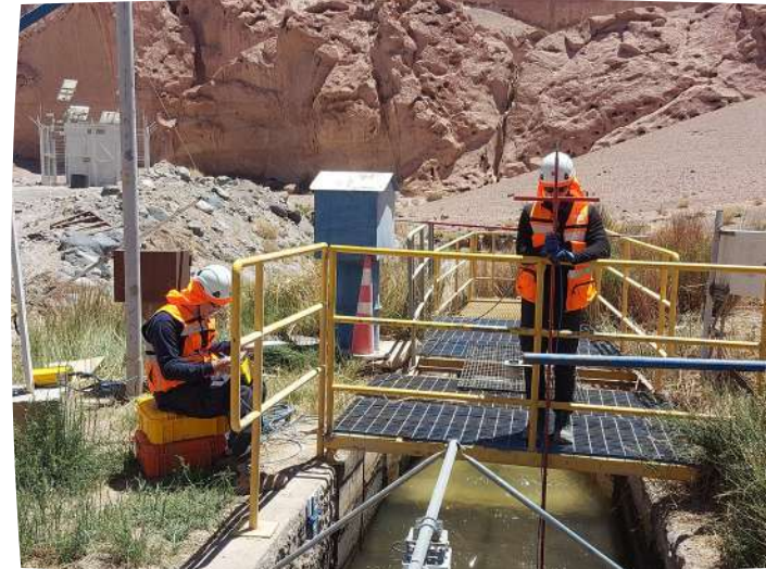
Procedimiento medición del caudal en el área de estudio.
