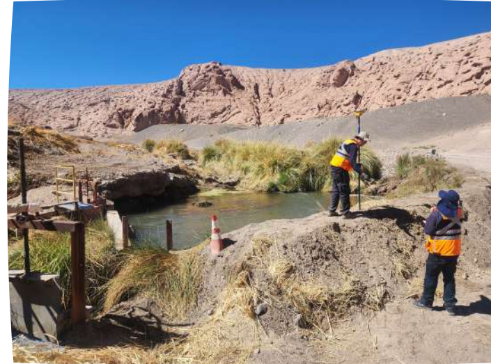
Levantamiento con estación total y GNSS RTK.
