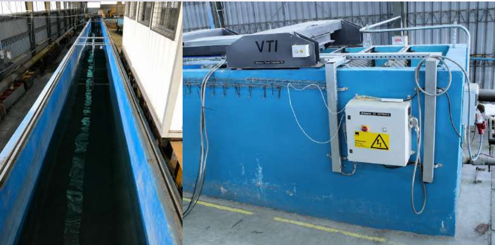
IMAGEN IZQUIERDA. Canal bidimensional de olas. IMAGEN DERECHA. Paleta 2D.
